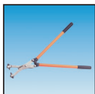
MÜPRO Trapezblechzange Lochzange für Trapezbleche bis 1,25 mm Stärke zum Anschrauben von Trapezblechhängern Maulöffnung von 78 mm auf 10 mm
