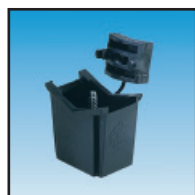
MÜPRO Universalhalter für Beschilderungssystem unabhängig vom Rohrdurchmesser, Befestigung direkt auf dem Rohr, kein Bohren, kein Schweißen, temperaturbeständig bis 140 °C, auch mit Edelstahl- Schraube (V2A) lieferbar
