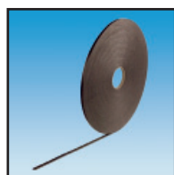
MÜPRO Vorlegeband für Lüftungskanäle geschlossenelliges Polyethylenband, ideal für Abdichtungen im Luftkanalsektor, einseitig selbstklebend, zugverstärkt mit Fadengelege
