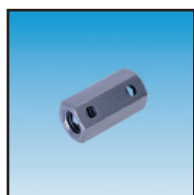
MÜPRO Gewindemuffen mit Sechskant mit Querbohrung zur Kontrolle der Einschraubtiefe (bei M8 bis M12) verzinkt
